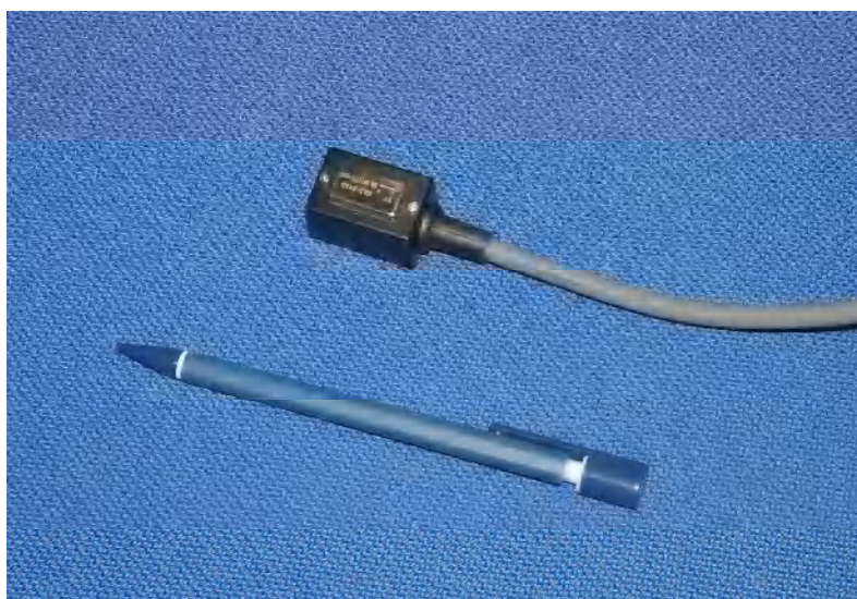
図 1. 小型精密加速度計、ケーブル先端のセンサーを被験者の肩部に設置し、上下、左右および前後方向の 3 軸の加速度を測定した。
